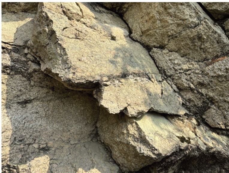
Рис. 3. Поверхность стенок трещин ЗСЗ простираения - притертая, трещина заполнена глиной трения, видны зеркала скольжения
