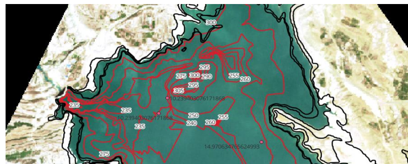
Фрагмент схемы исходных данных для создания ЦМР Чиркейского водохранилища
