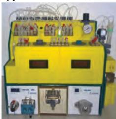
На основе накопленного опыта эксплуатации автоматизированных модулей синтеза в радиохимической лаборатории ФГБУ «ННПЦССХ им. А. Н. Бакулева» и появившейся на рынке новой элементной базы НПФ «Позитом-ПРО» разработала новый автоматизированный модуль синтеза для наработки широкого спектра РФП для ПЭТ, меченных <sup>18</sup>F, в частности <sup>18</sup>F-тимидина, технология производства которого проходит отладку в радиохимической лаборатории ФГБУ «ННПЦССХ им. А. Н. Бакулева».
