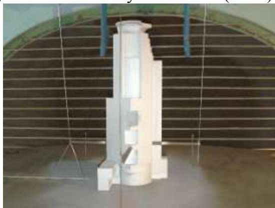
Рис. 2. Макет здания в аэродинамической трубе
