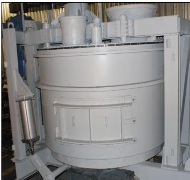
Рис. 1. Смеситель IMG емкостью 3000 л
