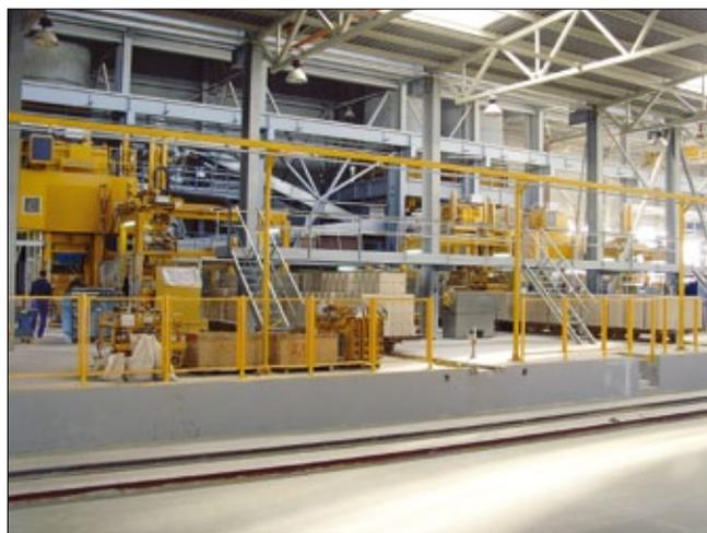
**Рис. 6.** Сердцем производства являются три полностью автоматических прессы, легко управляемых одним оператором
