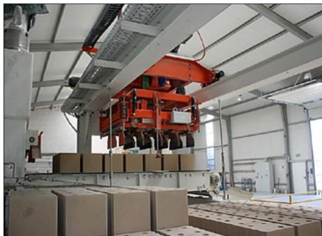
**Рис. 4.** Смонтированный с прессом автомат-укладчик с помощью собственных различных программ приспособляется к конкретным обстоятельствам (размерам кирпича, автоклавных вагонеток, автоклавов, схеме укладки заготовок) и бережно укладывает кирпич-сырец на рядом стоящие автоклавные вагонетки
