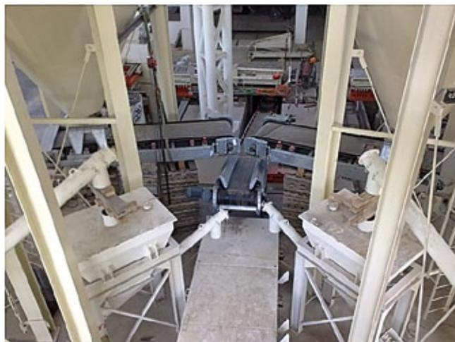
Рис. 2. Исходные материалы – песок и известь смешиваются в соответствии с рецептурой. Компьютерное управление дозированием воды следит за соответствием предварительно заданных параметров
