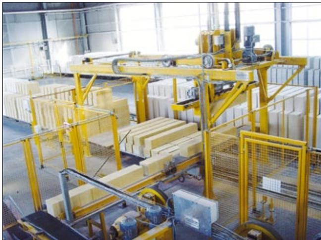
Рис. 11. Автоматический грейфер-съемник для линии раскола и боссировки
