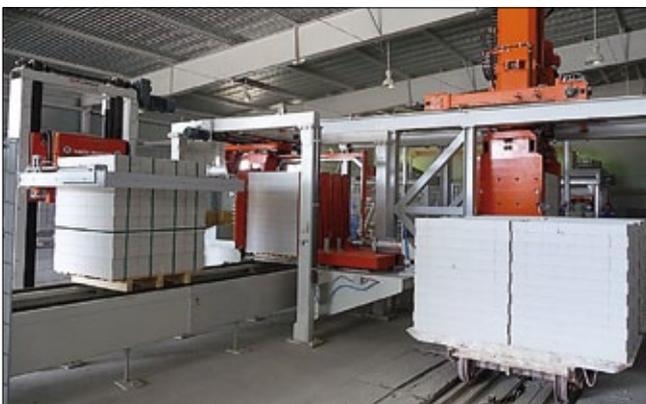
**Рис. 5.** Высококачественный кирпич перед отправкой к покупателям составляется на поддон. Для надежной транспортировки и для защиты от повреждений кирпич обвязывается горизонтально и вертикально полимерными лентами и затем упаковывается в полиэтиленовую пленку. Горизонтальное обвязывающее устройство является частью упаковочной линии
