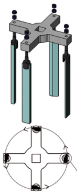
Рис. 2. Стандартный смесительный инструмент для первичного перемешивания силикатной массы до силосов
