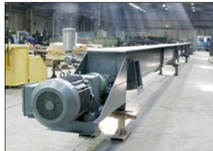
Рис. 7. Шнековый транспортер RUD Ketten
