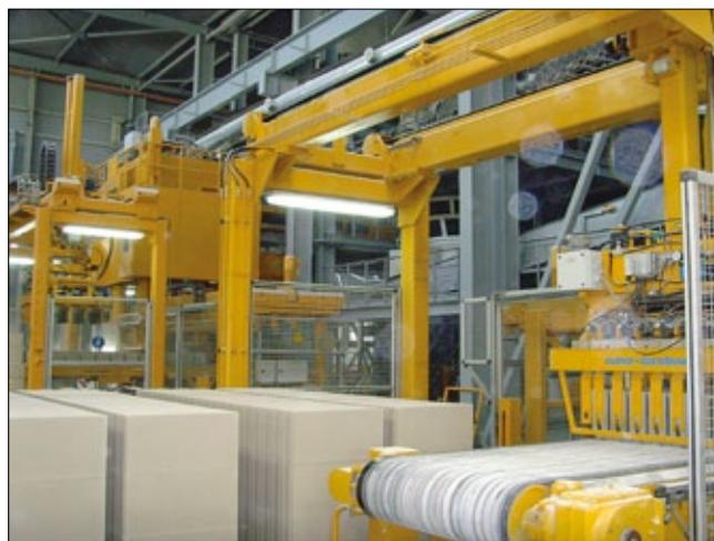
**Рис. 7.** Производство кирпича для внутренних перегородок со следующими размерами: длина 500 мм, высота 250 мм и толщина 100 мм. Это новая продукция, которая становится популярной в странах СНГ
