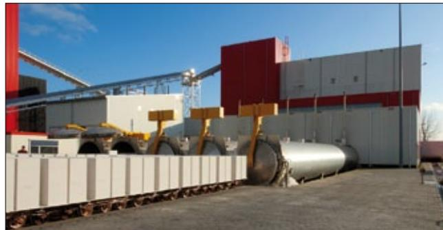
**Рис. 5.** Автоклавы для запаривания изделий. В этой зоне будут установлены дополнительные автоклавы, так как количество запариваемых изделий возрастет в связи с увеличением производительности зоны прессования
