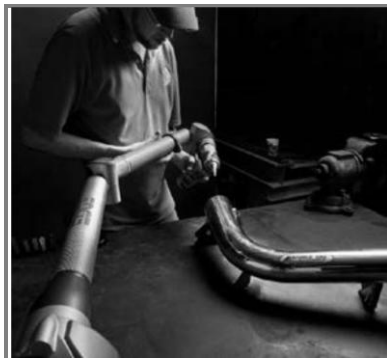
1. ábra: FARO letapogató csőgyártás közben [2.]
