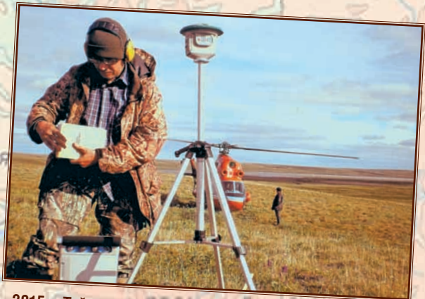
2015 г. Таймыр. АО «Гравиметрическая экспедиция № 3». Оператор Д.В. Брызгалов с гравиметром CG-5 «Scintrex»
