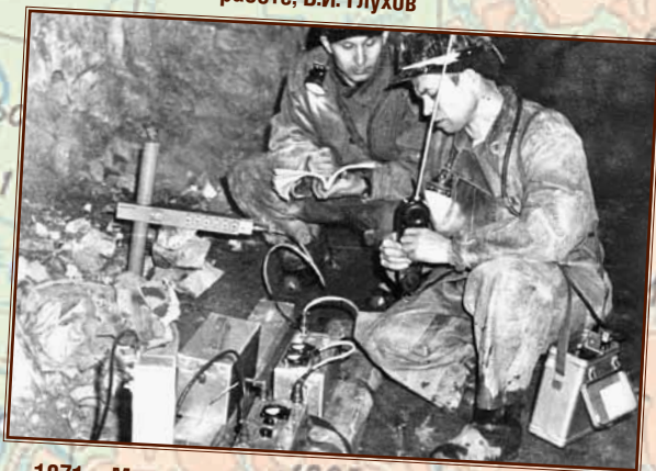
1971 г. Медвежье золотосульфидное месторождение, Артемовский рудник, шахта № 7. Л.Г. Афанасьев, В.Ф. Лебедев с аппаратурой радиоволнового просвечивания РИФА (разработка НПО «Сибцветметавтоматика»)
