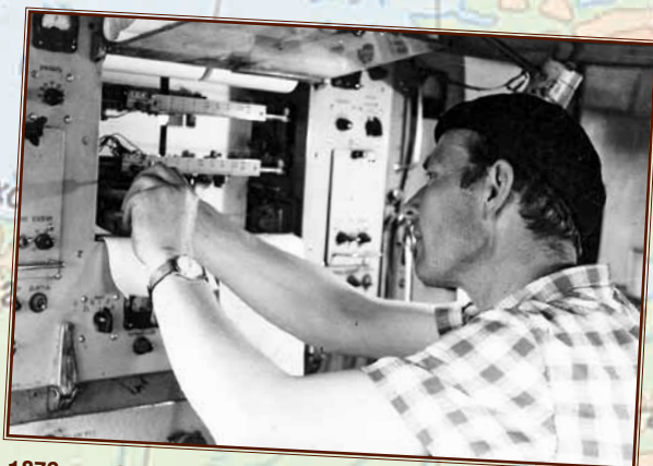
1970-е гг. На каротаже, подготовка регистратора ПАСК-8 к работе, В.И. Глухов
