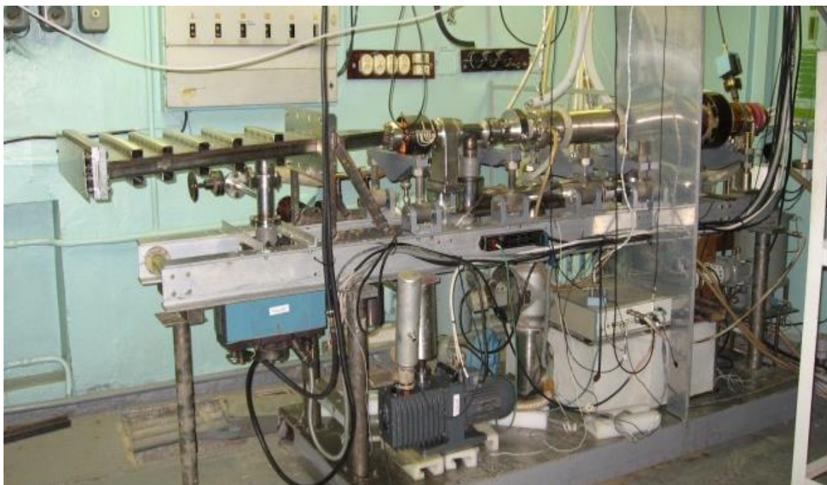
Рис. 1. Экспериментальный образец линейного ускорителя электронов на энергию 10 МэВ и мощность пучка 30 кВт
