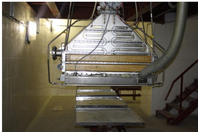
Рис. 6. Ускоритель ИЛУ-10 (сверху), его выпускное устройство и конвейер (снизу) в Парке ядерных технологий, г. Курчатов, Казахстан.
