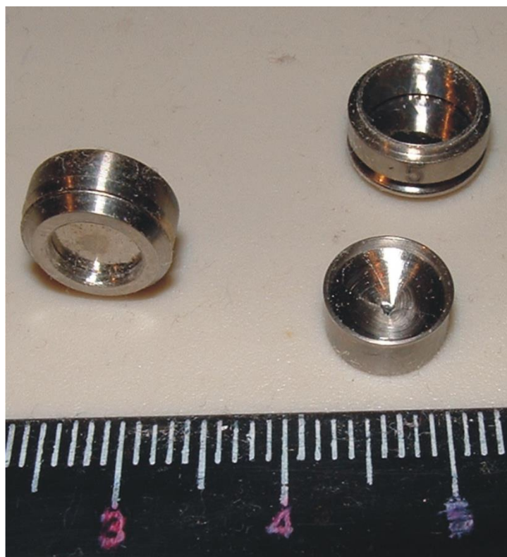
Рис. 2. Закрытый источник альфа-излучения:
