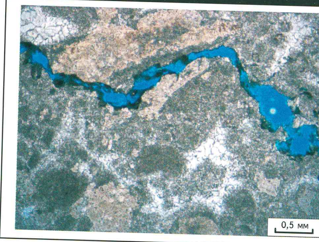
Рис. 5. ОТКРЫТАЯ СТИЛОЛИТОПОДОБНАЯ ТРЕЩИНА С ПУСТОТАМИ ВЫЩЕЛАЧИВАНИЯ В ОБЛОМОЧНОМ ОКРЕМНЕННОМ ДОЛОМИТЕ
