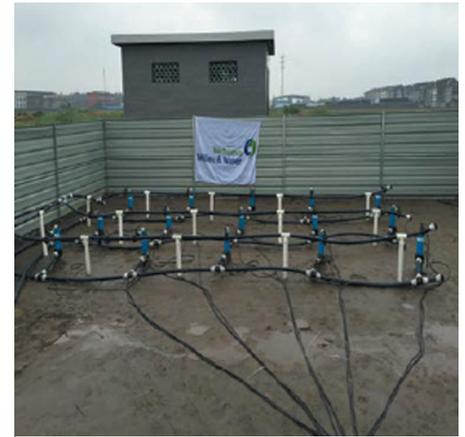
Рис. 3. Полевая установка для электрокинетической очистки территории от тяжелых металлов: система катодов (синие оголовки) и анодов (белые) [11]
