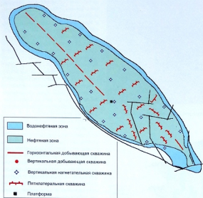
Рис. 4. Многолатеральная система размещения скважин на Приазловском месторождении
