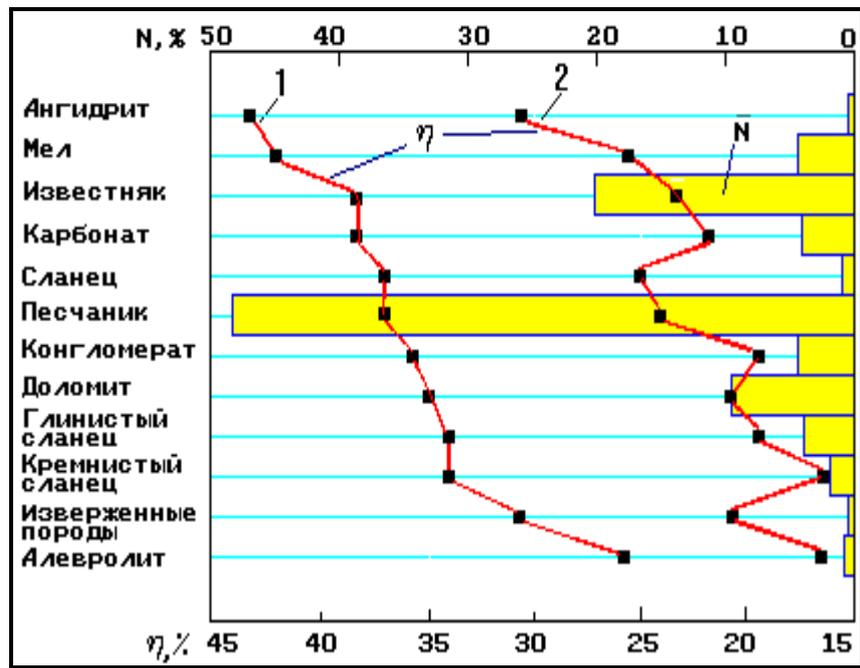
**Рис. 2.** Коэффициент нефтеотдачи ( $\eta$ ) и относительная частота встречаемости ( $N$ ) нефтяных залежей в зависимости от литологических типов пород
