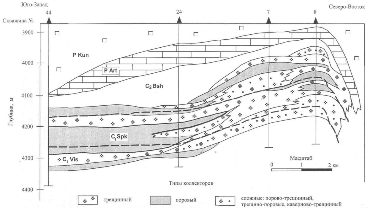
Рис.3 Модель типов коллектора месторождения Тенгиз по К.И. Багринцевой, 1999
