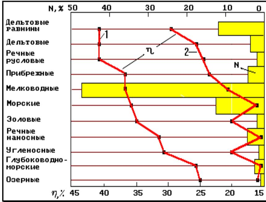
**Рис. 1.** Коэффициент нефтеотдачи ( $\eta$ ) и относительная частота встречаемости ( $N$ ) нефтяных залежей в зависимости от условий осадконакопления
