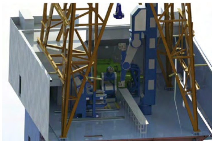
Рис. 2. Модернизация буровой установки в роботизированный буровой комплекс в испытательном центре Ullrigg в международном научно-исследовательском институте в Ставангера
